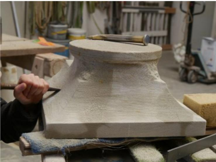
Anfertigen des Kapitells, das einen Übergang des runden Querschnitts der Säule zum quadratischen Querschnitt des Aufsatzes bildet.
