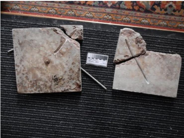
Die gebrochenen Bodenplatten wurden geklebt und rückwärtig vernadelt.
