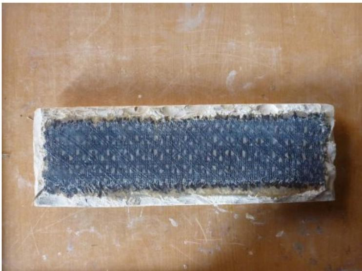
Die ausgebaute defekte Platte wurde gereinigt und zur Stabilisierung rückseitig mit einem Basaltfasergewebe verklebt.
