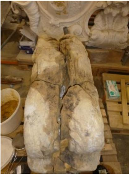
Zwischenzustand: Aufsicht auf den Stein, vorhandenen Riss wurden mit mineralischem Injektionsmörtel verfüllt.
