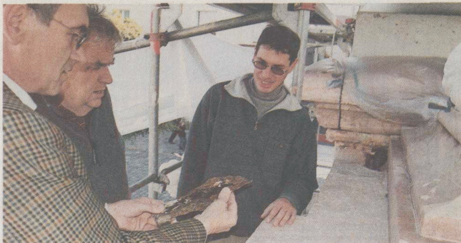
Steinmetzmeister und Restaurator Matthias Zschau (r.) zeigt Wolf-Dietrich Slotta (M.) und Alfons Huber einen alten Eisenhaken, der mittlerweile ganz brüchig geworden ist. An solchen Haken hingen bislang die beiden Seitenflügel der Dreifaltigkeitssäule.
